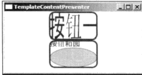
图10-4 在ControlTemplate中使用ContentPresenter
